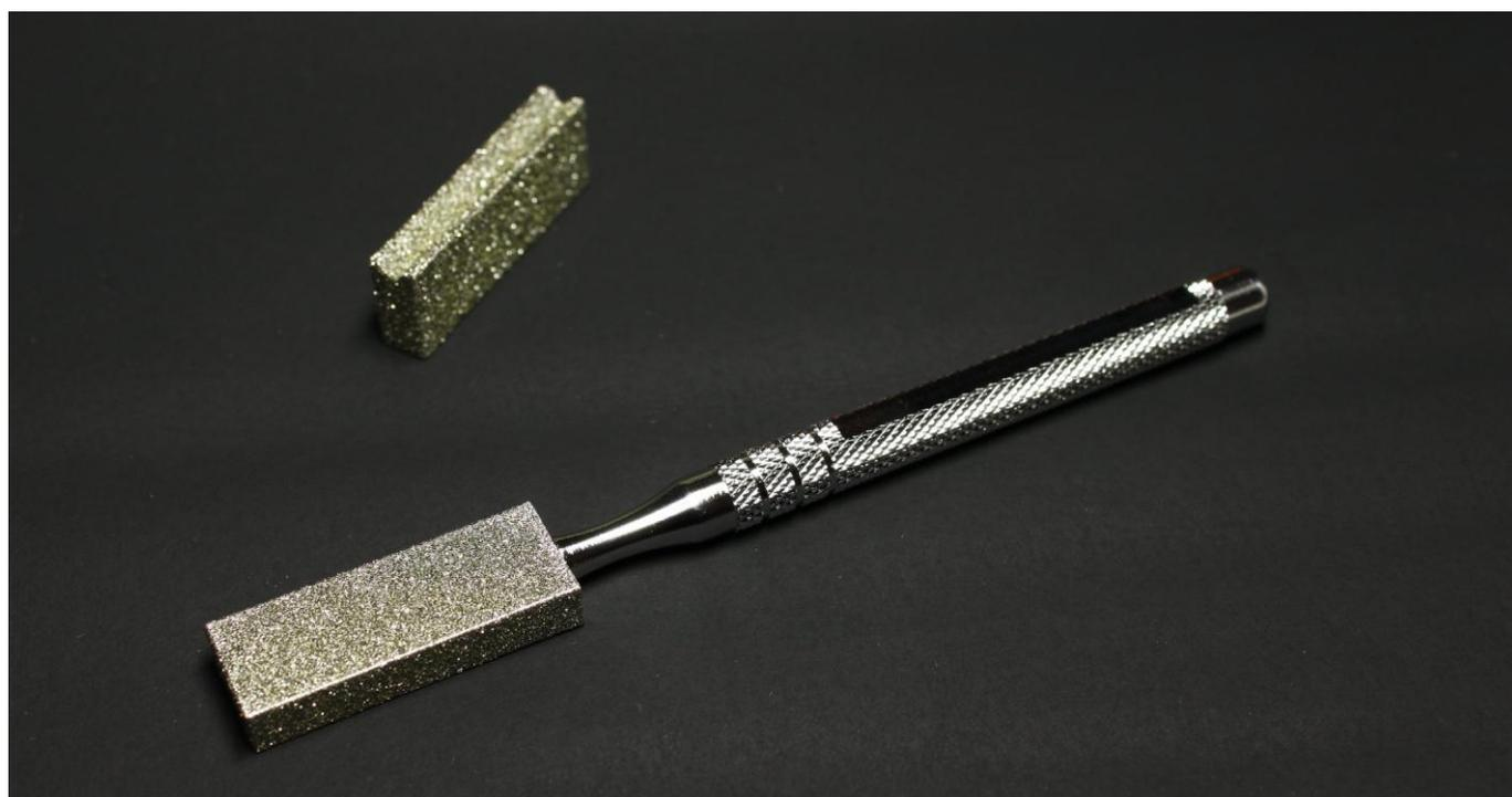
TKドレッサーの特徴は、先端部がハンドルから着脱可能になっており、荒めと中目の二種類を使い分けることが可能です。いずれの二種類の先端部にはV字溝が入っており、ポイント類やホイール類を自在にドレスアップすることができます。
